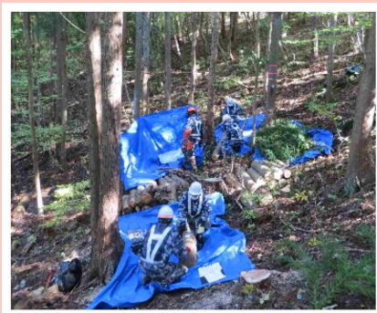
▲ 立木の部位ごとの放射性物質濃度調査
