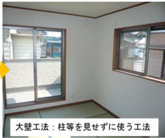
大壁工法：柱等を見せずに使う工法
