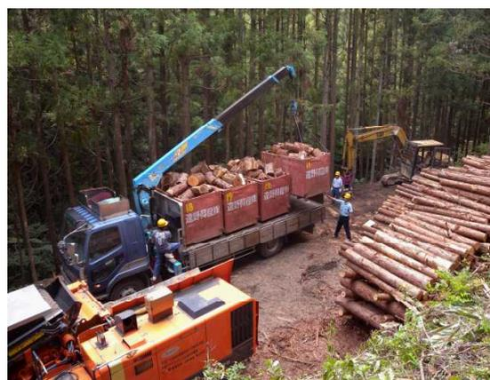
林地残材搬出用専用コンテナによる運搬の様子
