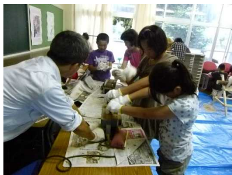
ベルトサンダーで側面を削ります
