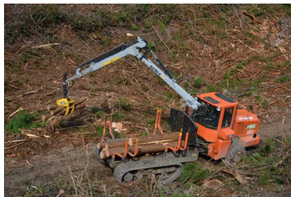
フォワーダでの積み込み作業
