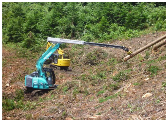
ロングリーチグラップルによる集材作業
