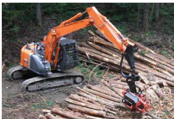
高性能林業機械(プロセッサ)を使った造材作業
