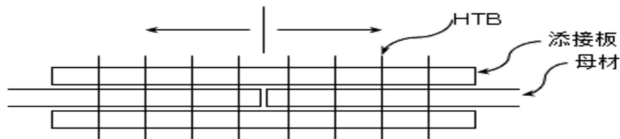
図7-1 ボルト締付け順序
