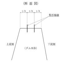
「注2」 挿筋本数は水平打継面1m<sup>2</sup>当たり1.30本。 セットする位置は、水平打継面の上下流から断面寸法の おおむね1/3の箇所に2列均等配置を標準とする。 また、2列配置とした時に隣接する挿筋の間隔が 10cm以下となる場合又は施工上支障がある場合などは、 列間隔をおおむね1/4とし3列均等配置とすることができる。 なお、型枠、伸縮継目、基礎地盤等から最小10cm以上の 距離を確保すること。
