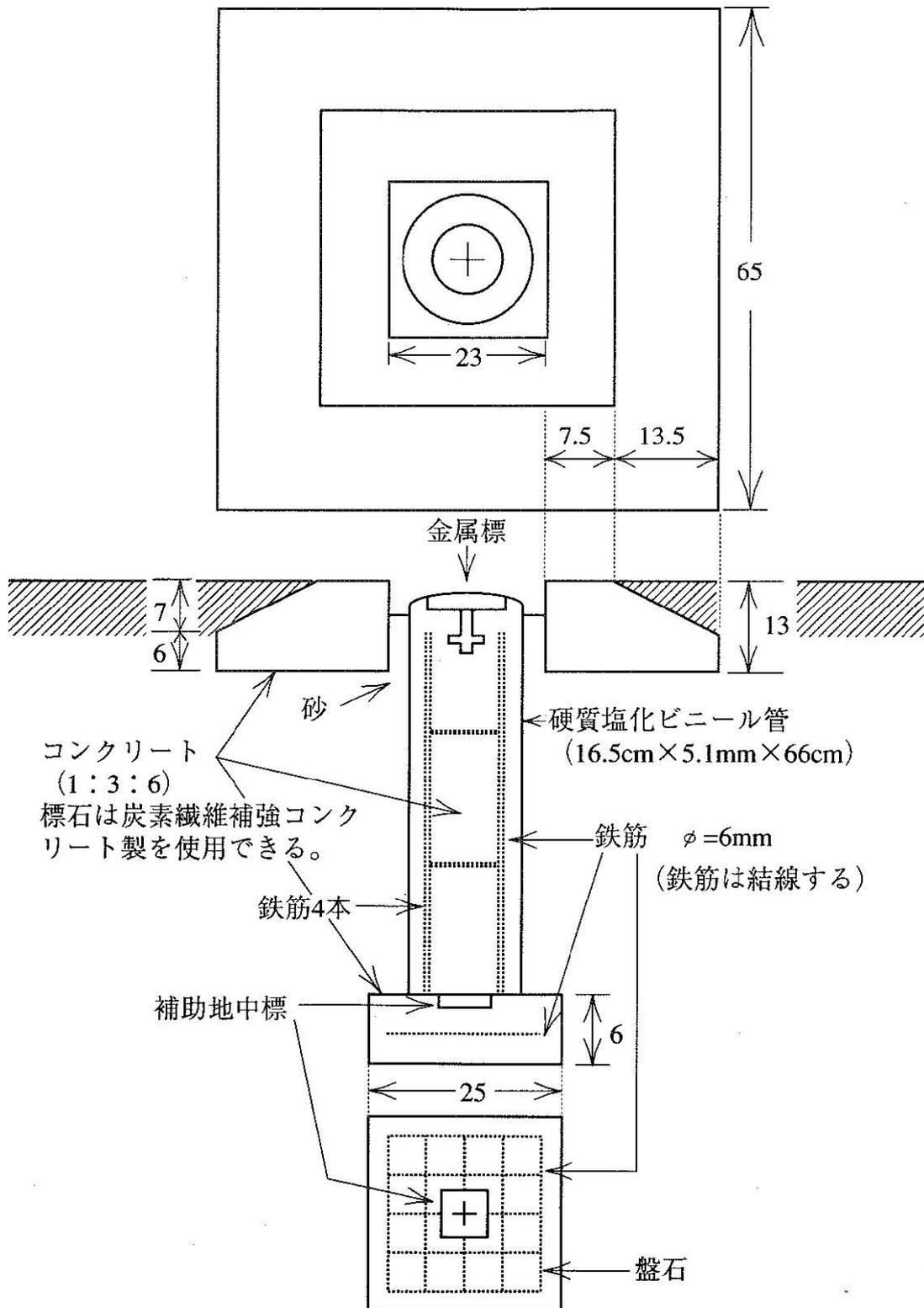
3) 図根点 (金属標) 屋上埋設図 (その1)
