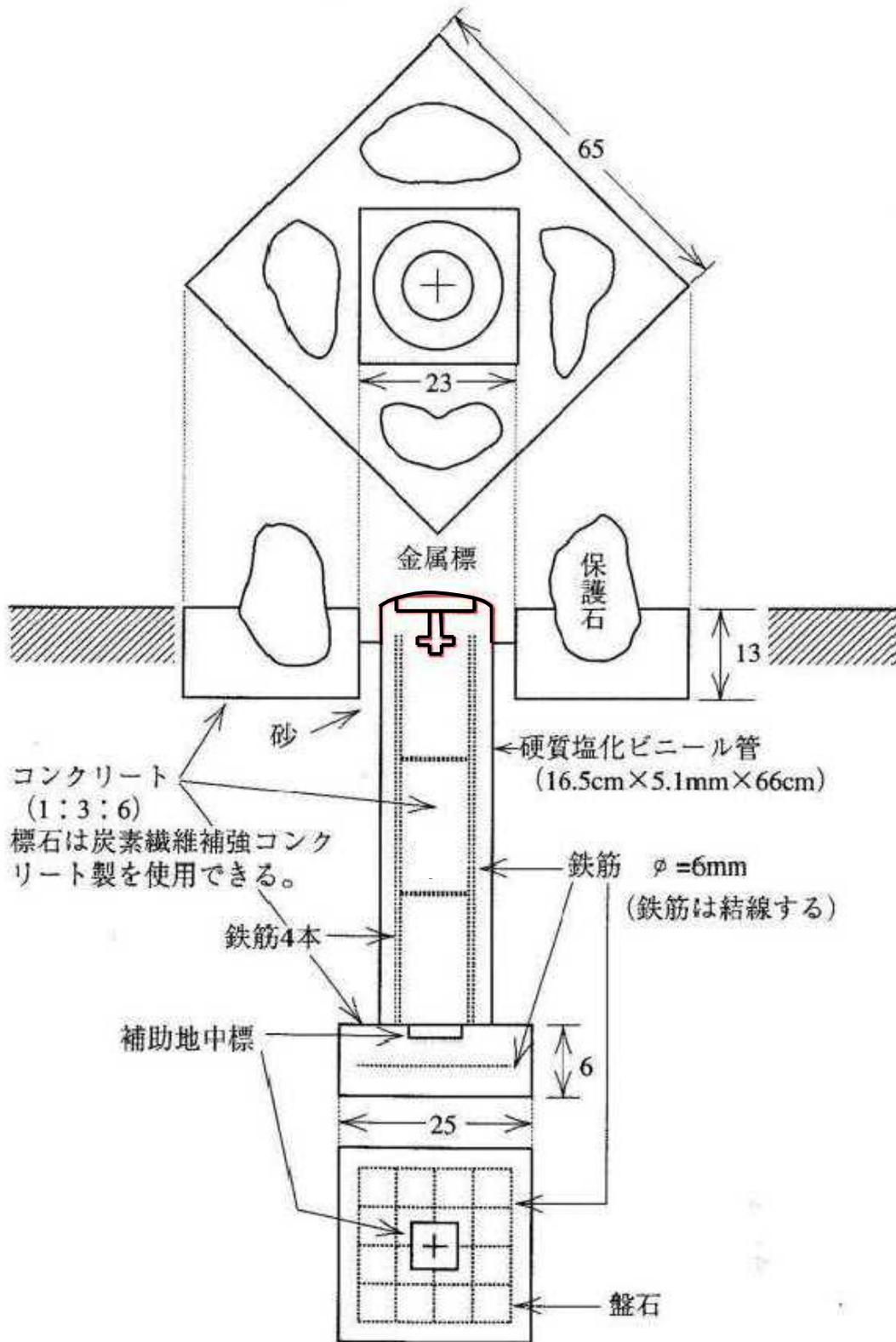
2) 図根点 (金属標) 地下埋設図
