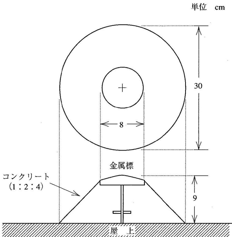
4) 図根点 (金属標) 屋上埋設図 (その2)
