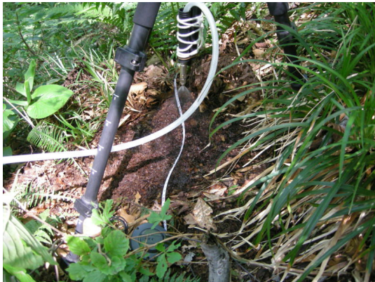
緑のダム実験（透水時間計測中）
