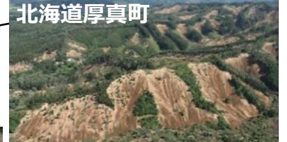
北海道胆振地方中東部を震源としたマグニチュード6.7の地震により、厚真町北部を中心に13km四方の範囲で山腹崩壊が集中的に発生。
