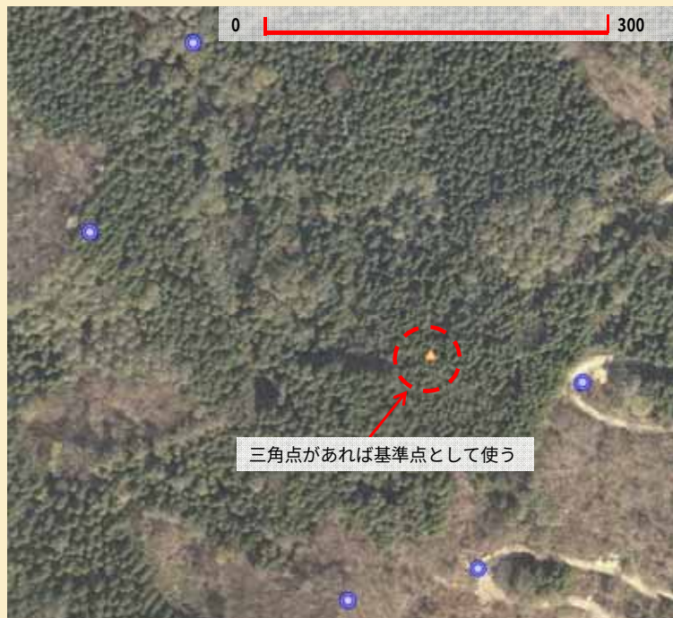
基準点を300～500m間隔で設置
