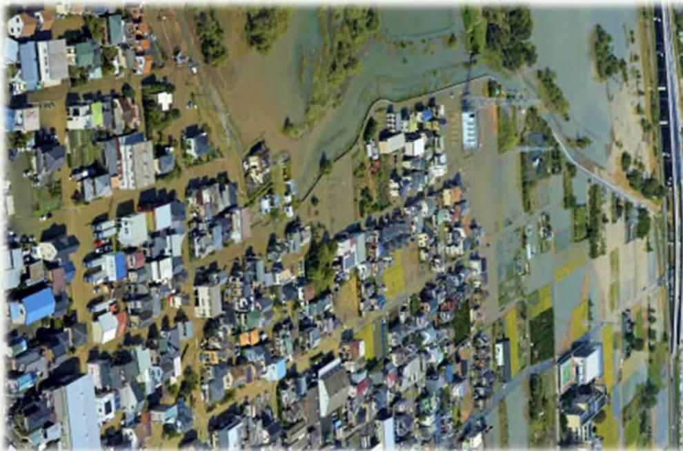
巴川上流部では放任竹林の枯れ竹が流れだして水路を塞ぎ、土砂が堆積してオーバーフローしてしまった。
