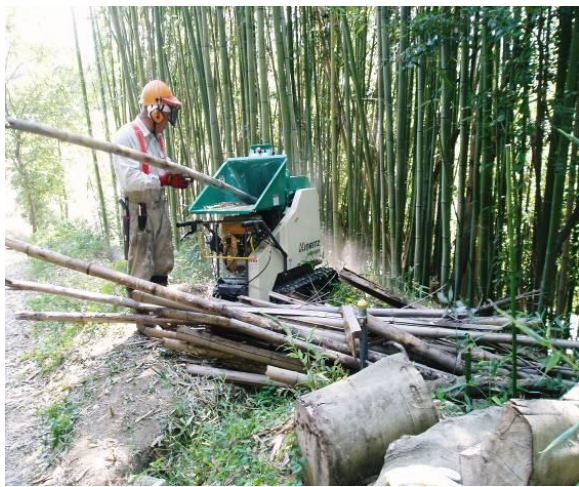
集積したタケをチップパー（木竹粉碎機）により粉碎している様子
