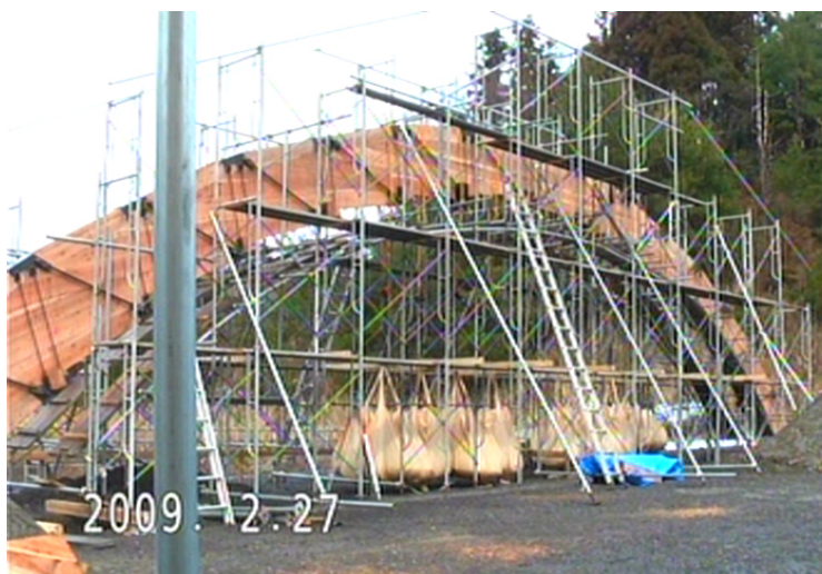
中央荷重の実物大実験
