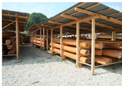
丸太材(スギ材)の乾燥状況
