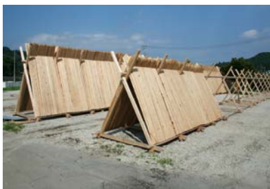
壁板材(スギ材)の乾燥状況
