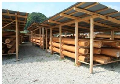
丸太材(スギ材)の乾燥状況
