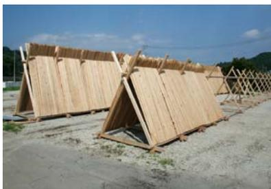
壁板材(スギ材)の乾燥状況
