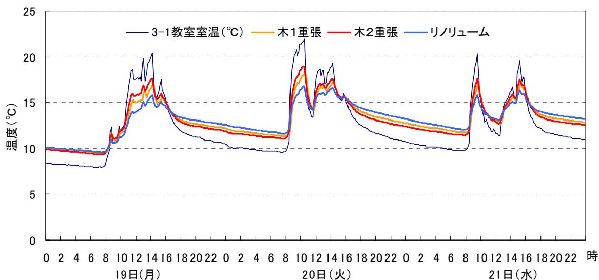
図1 床仕上げ材による床表面温度の相違
