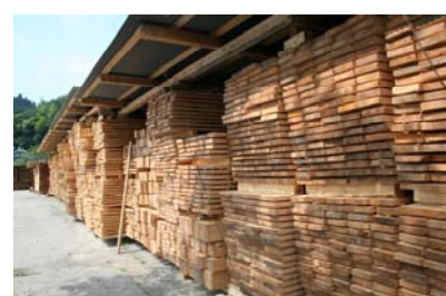
床板材（ヒノキ）の乾燥状況
