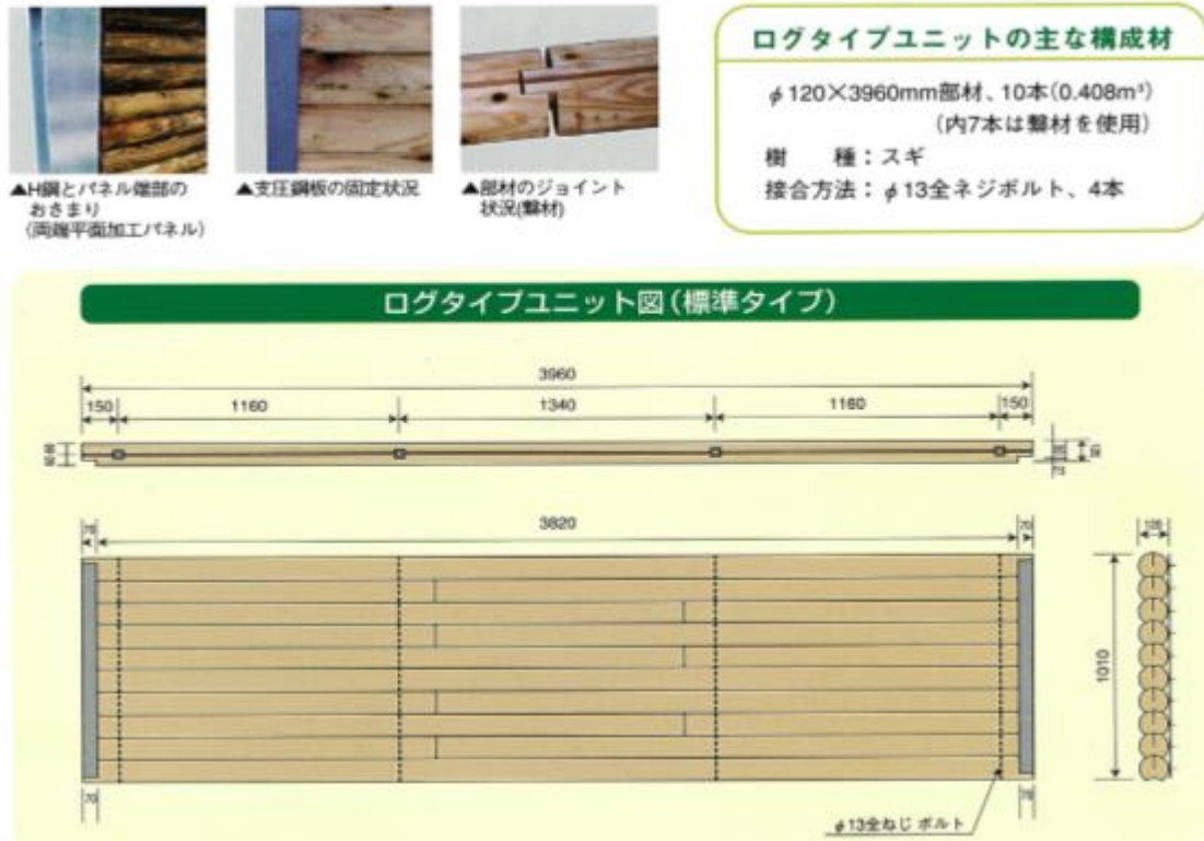
図 3-133 群馬県における木製遮音壁（ログタイプ）の仕様
