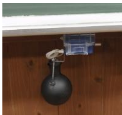
図 3-74 左：温度計測器 中央：温湿度計 右：グローブ温度計（いずれも T&D 社製）
