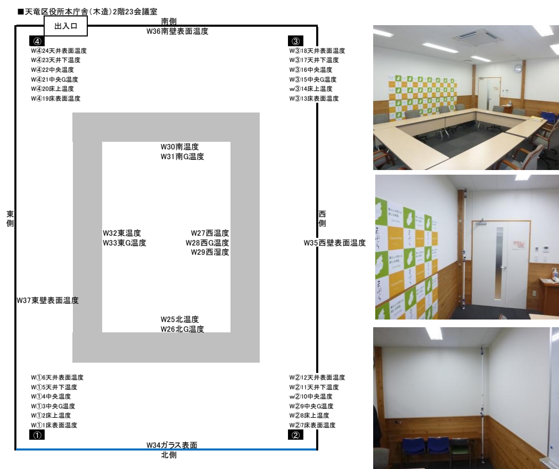
図 3-107 計測器の設置箇所（木造庁舎の会議室）
