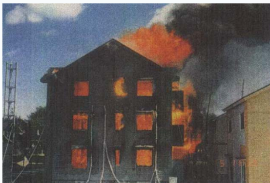
木造3階建て共同住宅の実大火災実験における火災最盛期の様子(平成8年3月)
