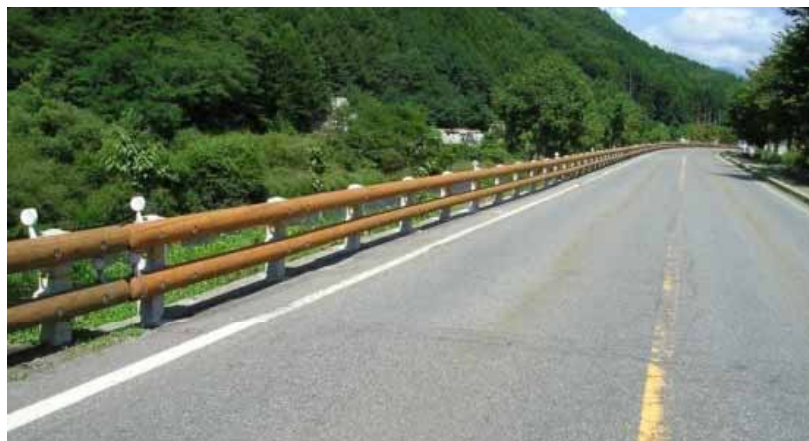
A. コンクリート支柱、カラマツ(円柱加工)
