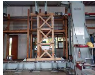
（耐力壁試験状況）
