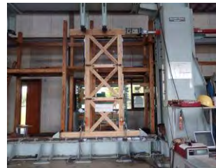
（耐力壁試験状況）
