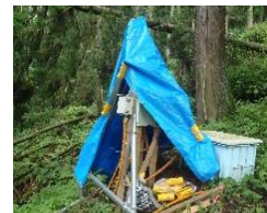
水位・ひずみ計による調査
