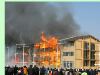
実験校舎を用いた 火災実験の様子
