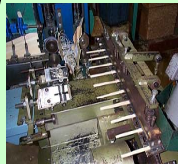
割り箸の製造（成形工程）
