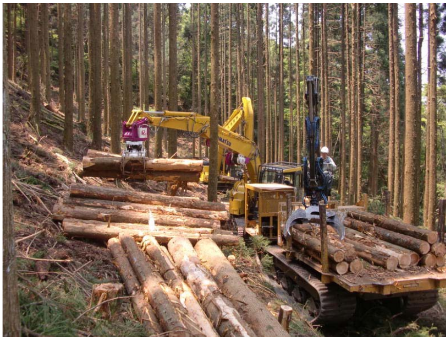
フォワーダへの木材の積み込み作業（九州森林管理局）
