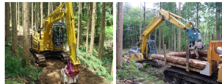
路網と高性能林業機械を組み合わせた作業システム
