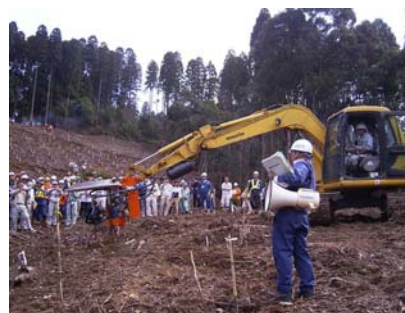
改良型コンテナ苗自動耕耘植付機によるコンテナ苗の植付
