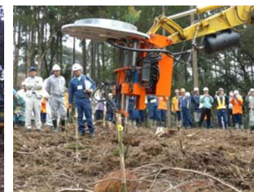
改良型コンテナ苗自動耕耘植付機によるコンテナ苗の植付
