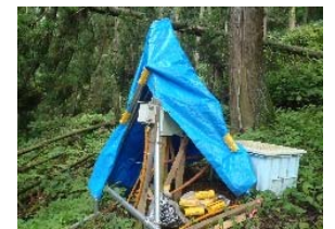
水位・ひずみ計による調査
