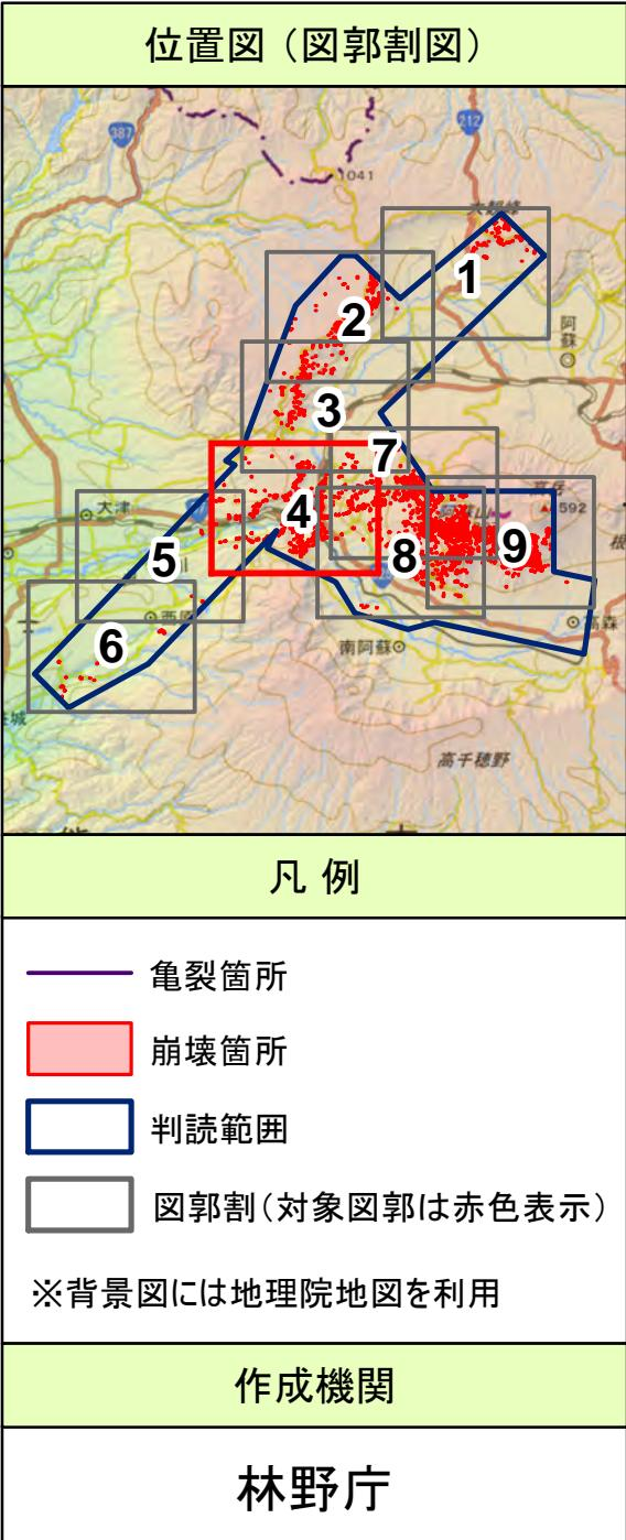
①平成28年4月19日～4月29日に計測した航空レーザ計測データ(計測密度:4点/m<sup>2</sup>)を用いて、山地等で発生している崩壊及び亀裂箇所を判読して作成しています。
