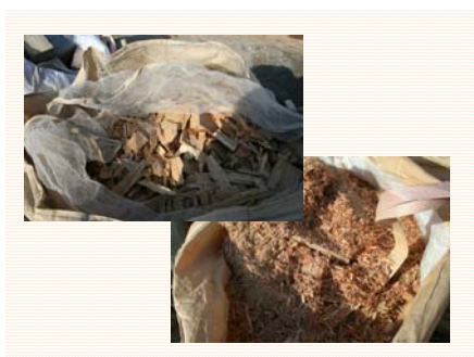
製材時に発生したオガ粉
