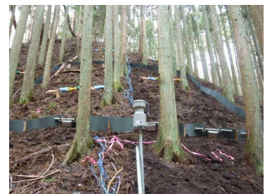
試験斜面枠と雨量計 （右：落葉除去、左：落葉除去なし）
