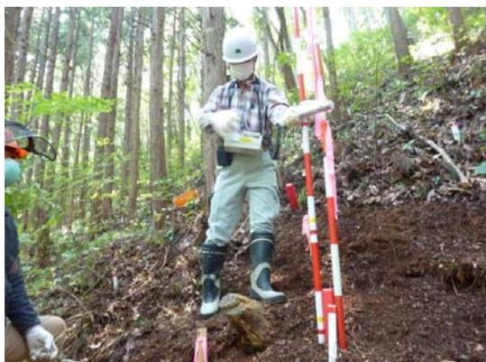
写真5 除去後の空間線量率の測定
