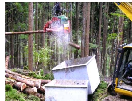
端尺部をバックン上で切り落とす様子
