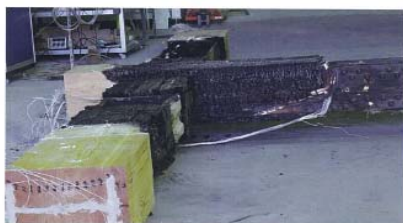
接合部試験体 (加熱 24 時間後)
