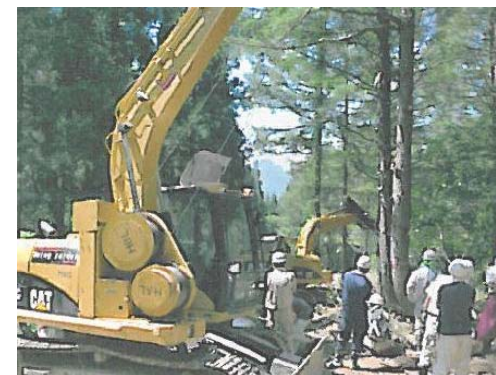
現地研修 スイングヤーダによる集材作業
