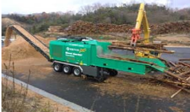
チップ加工業者による森林バイオマスのチップ化
