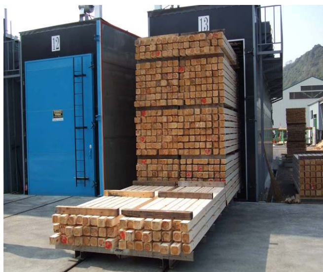
木材乾燥機500m 3 (高温12基、中温1基)
