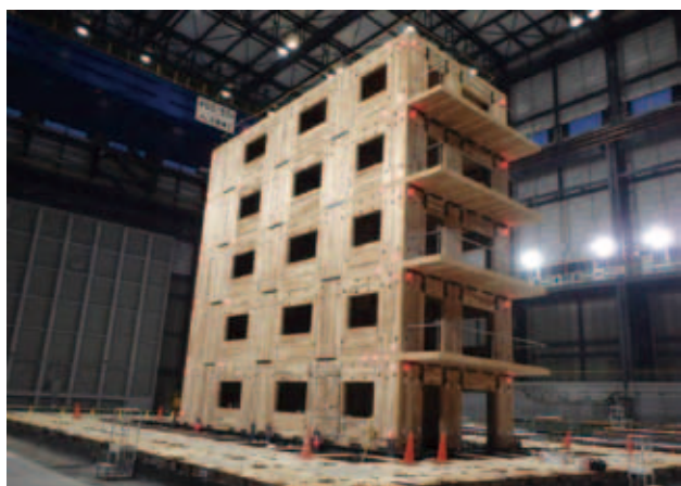
5階建て震動台実験写真（2015年2月 E-ディフェンス、兵庫県三木市）
