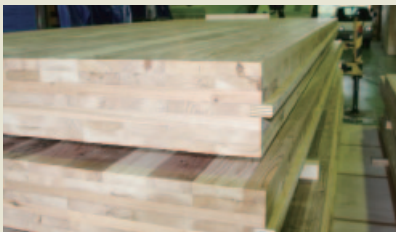
建築に使われるCLTパネル
