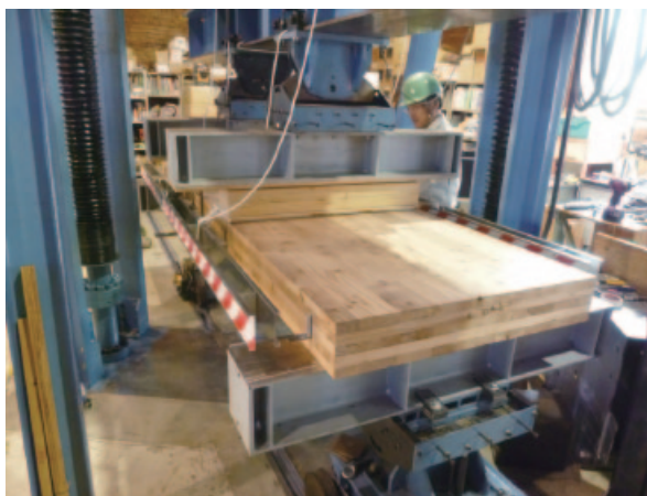
スギを用いたCLTの強度試験(写真提供：銘建工業㈱)
