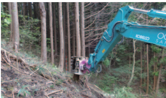
フェラーバンチャ付きグラップルバケットによる森林作業道支障木の伐倒作業
