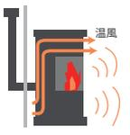
また、給気・排気の方法によっても、半密閉式と密閉式の2つに種類が分かれています。半密閉式は室内から給気して室外に排気する方式で、密閉式は給気・排気ともに室外から行う方式です。
