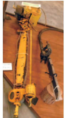
マーキュリー KB6AX(昭和20年アメリカ製)、終戦当時、日本に進駐していた米軍が使用していた2人用のチェーンソー。
