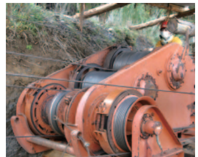
高知県でH型架線集材に用いられている集材機。
