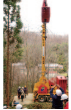
移動しやすく、架線集材が短時間で行えるタワーヤード。
