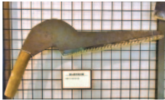
廻し挽き用大鋸、糸鋸のように小回りのきく大鋸。
