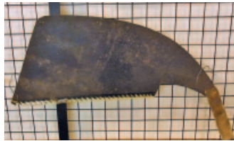
前挽鋸、製材などに使用される縦挽用の鋸。
