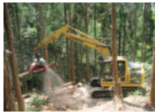
土場や作業道沿いに木寄せ集材した材を枝払い、玉切りするプロセッサ。
