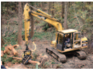
土場や作業道沿いに木寄せ集材した材を枝払い、玉切りするプロセッサ。
