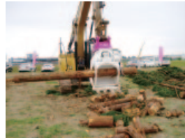
フェラーバンチャ機能と掘削機能が合体した複合機。
