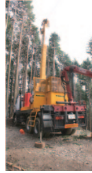
移動しやすく、架線集材が短時間で行えるタワーヤード。
