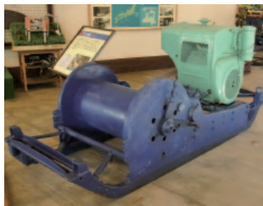
ウィッセン集材機 W30(昭和26年スイス製)、昭和20年にスイスで山岳林用に開発された集材機で、後の日本の集材機の発達に大きな役割を果たしました。
