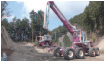
軟弱地盤でも確実な走破能力を確保する8輪型フェラーバンチャ。
