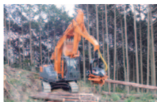
土場に集積した丸太の玉切り作業を行うハーベスタ。
