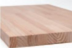
集成材は、板または小角材を木目方向に平行にして、厚さ・幅・長さ方向に集成接着した木材です。
