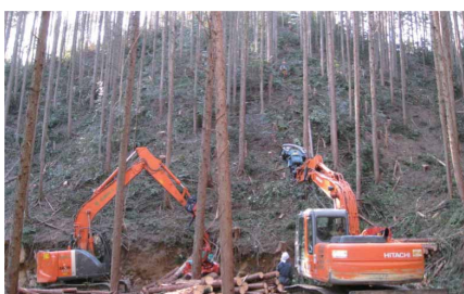
スイングヤードによる集材とプロセッサによる造材作業の様子(岐阜県下呂市)
