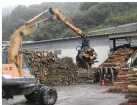
チップ製造ラインへの間伐材投入
