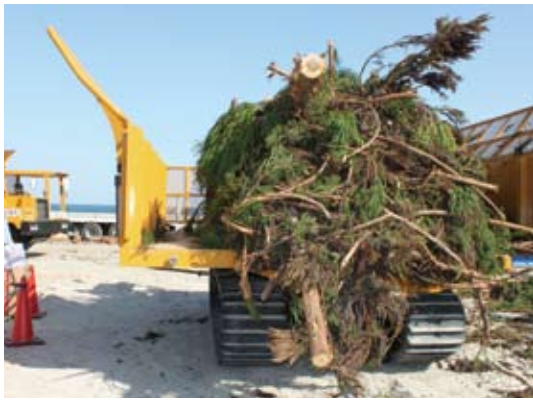
荷台上に圧縮機械が付いたバイオマス対応型フォワーダ
