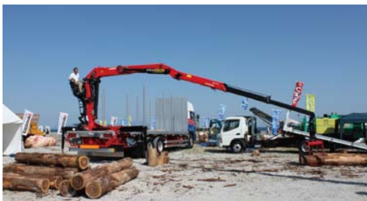
ロングアーム搭載型トラッククレーンの実演
