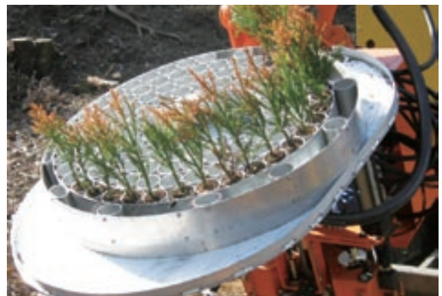
苗木がセットされたコンテナ苗自動耕耘植付機
