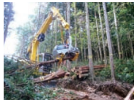
ウインチ付ハーベスタシステムによる造材作業2m、3m、4m材に仕分け(右から造材)フォワーダの積込みが容易である。
