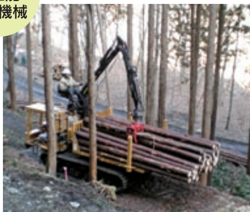
フォワーダ(積載集材車両) 玉切した材をグラップルローダで荷台に積んで運ぶ自走式機械
