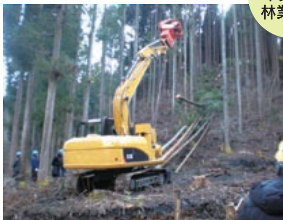
スイングヤーダ(簡易架線集材機) アームをタワーとして使用し、主索を用いない簡易な架線による集材機
